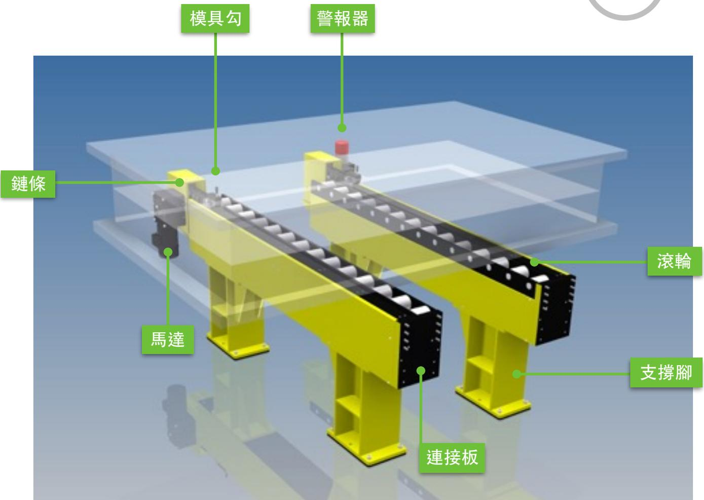
動力移模臂(PBE)改良自原本利用人力運輸模具的一般移模臂，藉助馬達的力量驅動，進而帶動鏈條輸送模具。模具利用連接座及模具勾和鏈條聯結，其中特殊設計的鏈條能夠提供絕佳的強度，保持在軌道上穩定運行。
